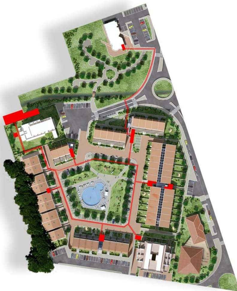
Parco di Plinio Roma: Schema Impianto e rete di teleriscaldamento
